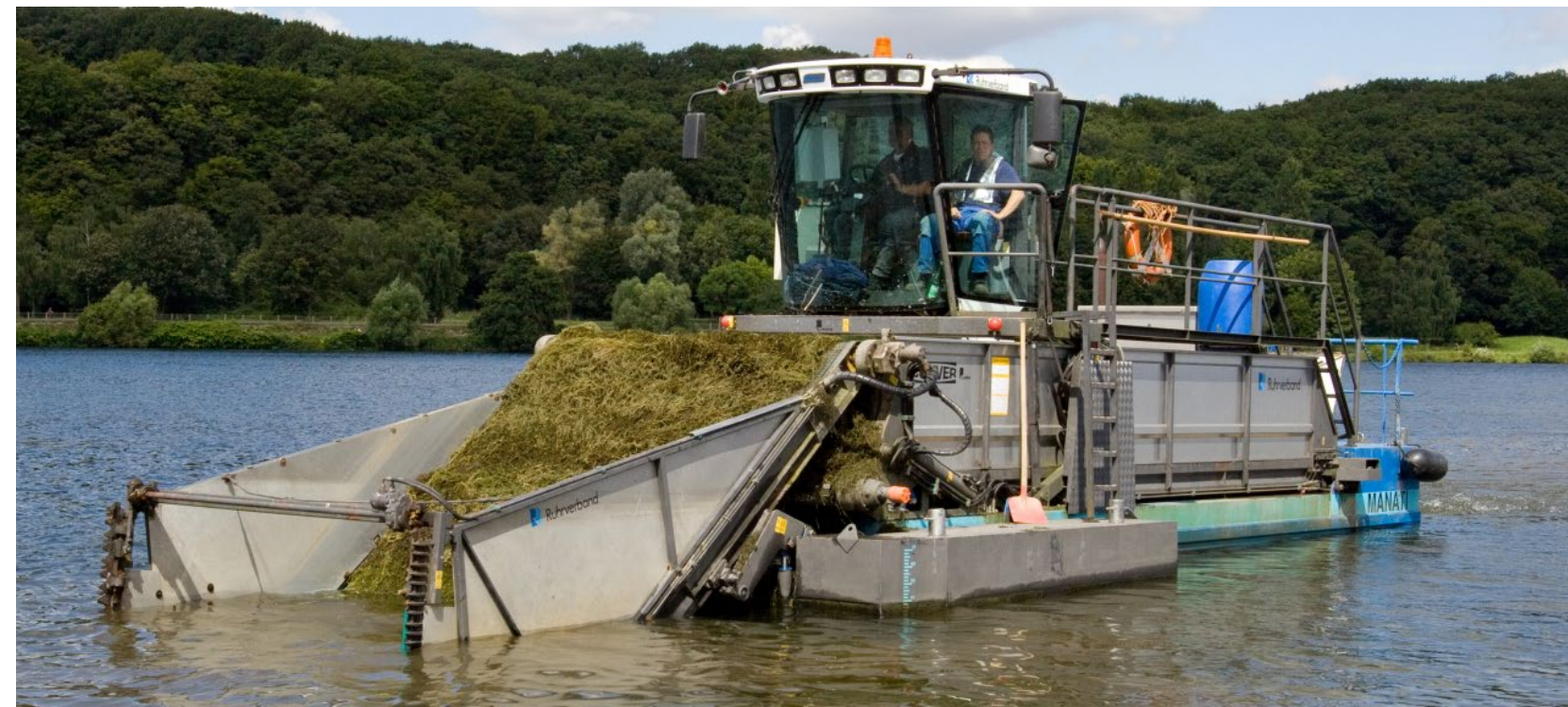
Das Mähboot „Manati“ kann erst zum Einsatz kommen, wenn die Pflanzen bereits an der Oberfläche sichtbar sind.
